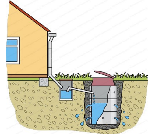
Puits d'infiltration Source : https://constructeurtravaux.fr
